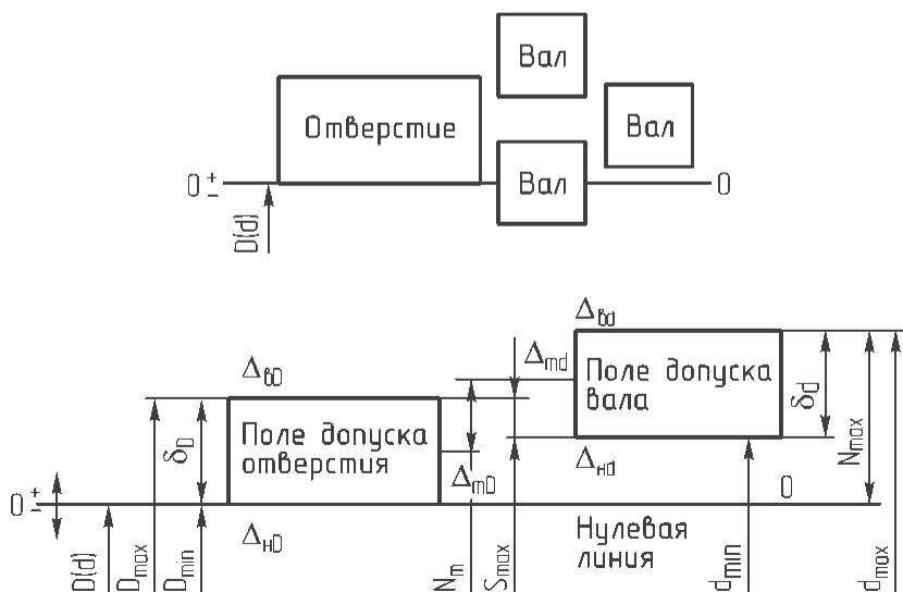
Рис. 1.4. Графическое изображение переходных посадок
