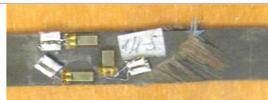
Рис. 5. Разрушение при растяжении образцов с укладкой волокон \pm 40^\circ
