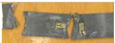
Рис. 8. Разрушение при сжатии образцов с укладкой волокон \pm 50^\circ
