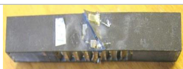
Рис. 10. Разрушение при сжатии образцов с продольной укладкой волокон
