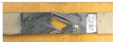
Рис. 7. Разрушение при растяжении образцов с укладкой волокон 90^\circ_2/\pm 20^\circ
