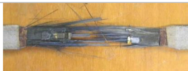
Рис. 6. Разрушение при растяжении образцов с продольной укладкой волокон
