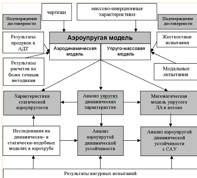
Рис. 1. Структурная схема программного комплекса
