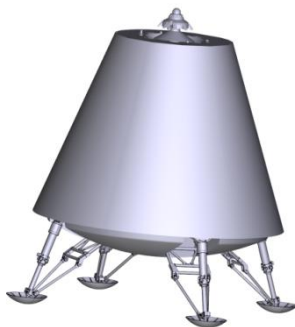
Рис. 1. Космический аппарат с пружинно-рычажным посадочным устройством.
