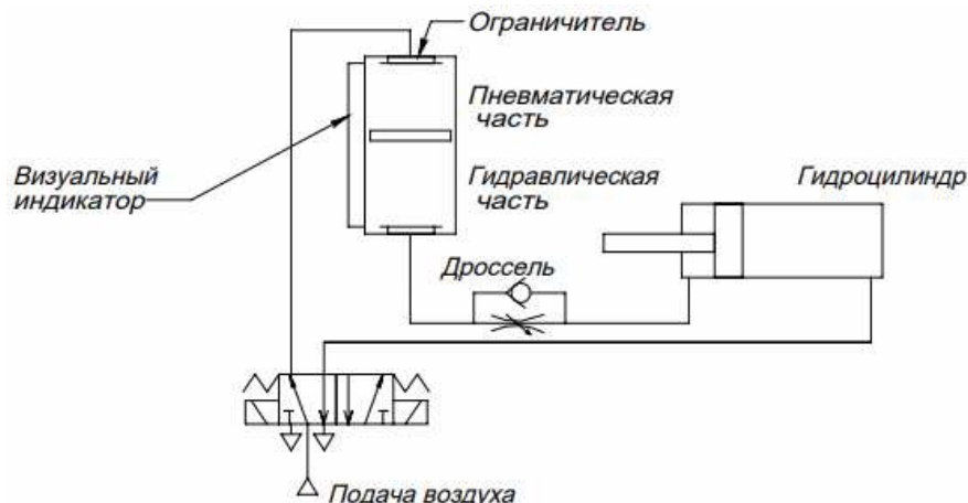
Рис. 3. Схема пневмогидравлического привода с воздушно-масляным резервуаром
