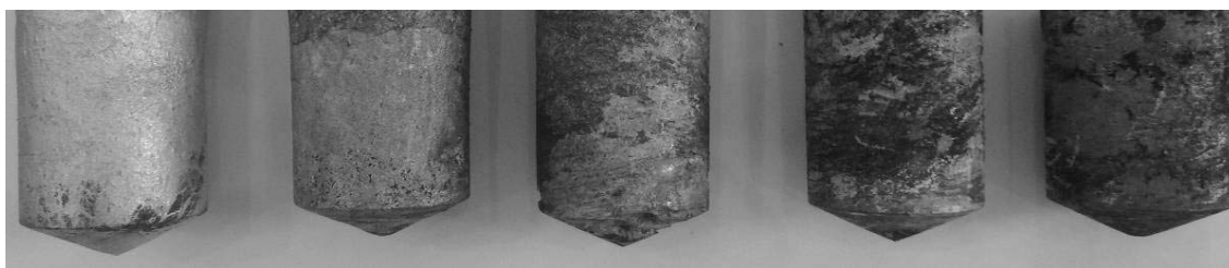
Рис. 1. Опытные отливки, увеличение концентрации частиц Al_2O_3 слева направо.
