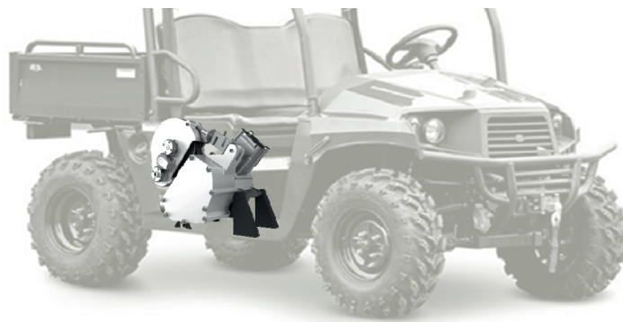
Рис. 3. Экспериментальная испытательная силовая установка, встроенная в конструкцию мотовездехода
