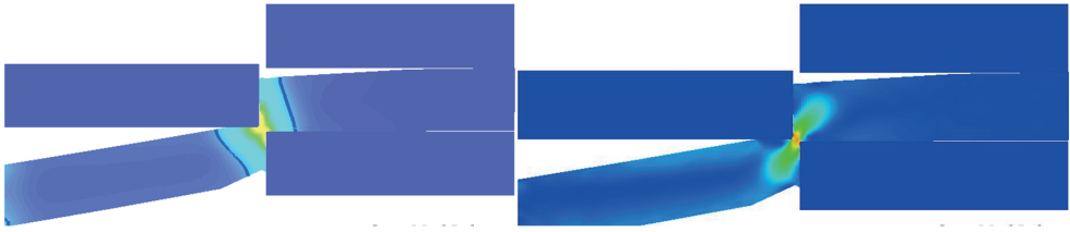
Рис. 1. Распределение осевых (слева) и касательных (справа) напряжений
