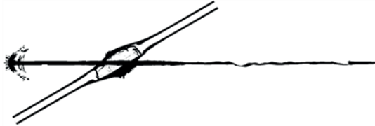
Рис. 2. Взаимодействие КС с невзрывным ЭДЗ, снаряженным оргстеклом. Толщина обкладок 2 мм, толщина слоя оргстекла 6 мм
