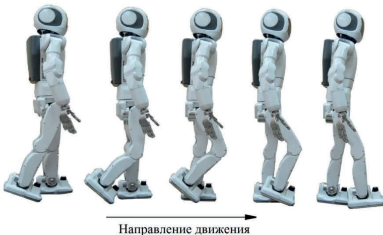
Рис. 3. Перемещение неопорной ноги робота по параболической траектории
