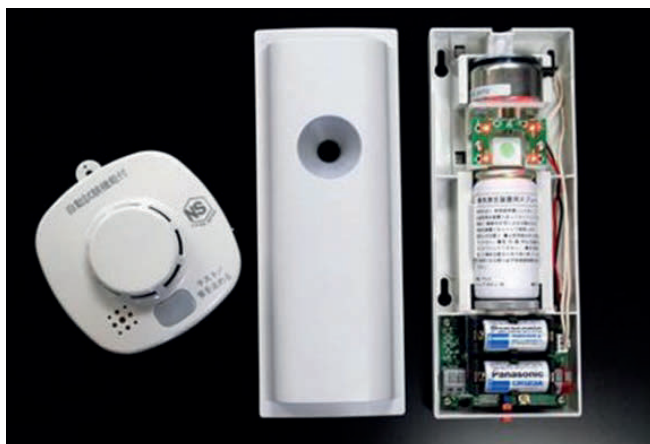
Рис.2. Аэрозольный оповещатель, распыляющий резкий запах васаби
