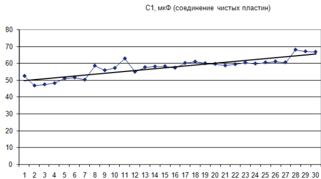
Рис. 3. Результат измерения емкости двух сопряженных пластин с различной толщиной и дефектностью
