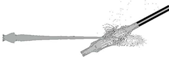
Рис. 3. Взаимодействие КС с взрывным ЭДЗ с керамическими пластинами-обкладками из Al 2 O 3 в момент времени 12 мкс. Угол наклона ЭДЗ к КС 30°
